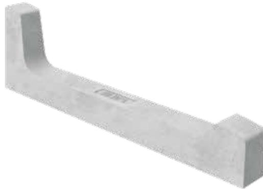
Die in den Neigungswinkeln 5° und 10° erhältlichen Mono-XL-Ballastelemente bieten eine einfache und vielseitige Lösung für große PV-Module: Die vertikale Befestigung verleiht den Modulen ein hohes Maß an Dichtigkeit und Stabilität, während die Möglichkeit, den Abstand zwischen den Reihen frei zu modulieren, eine schnelle Installation auch bei Hindernissen auf dem Dach gewährleistet.
